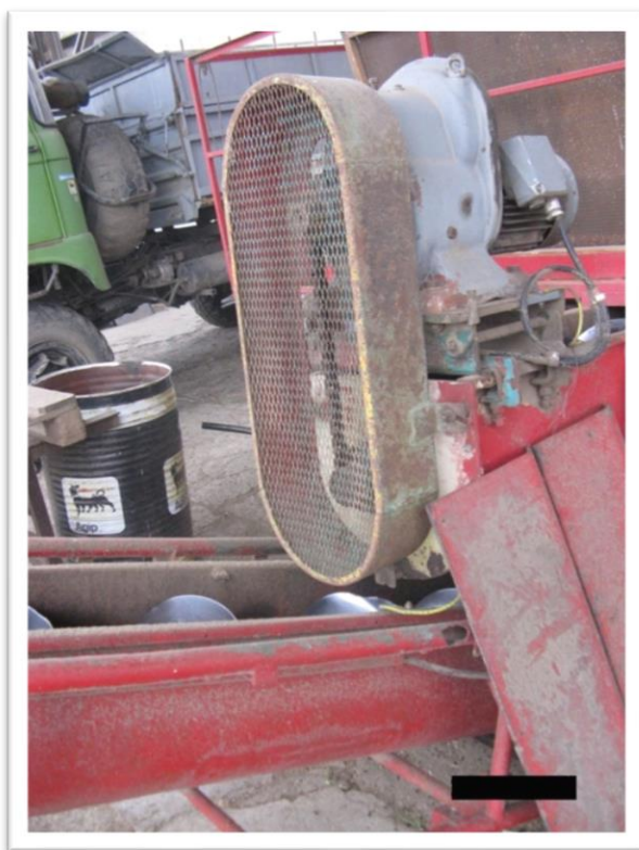
Burkolattal ellátott ékszíjhajtás, burkolatlan szállítócsiga.
