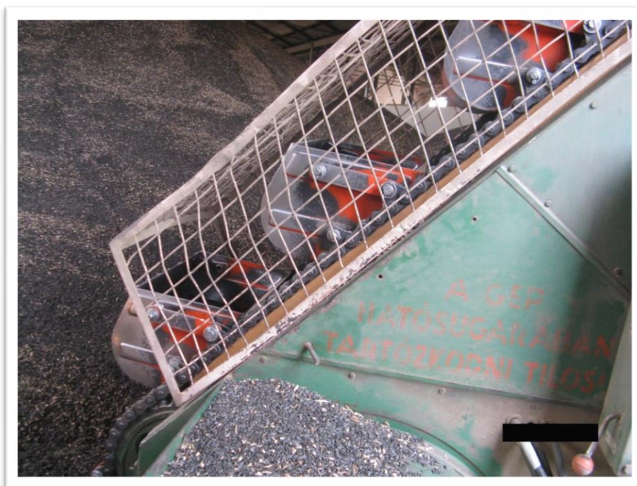
Serleges anyagmozgató gép védőrácscsal ellátva.
