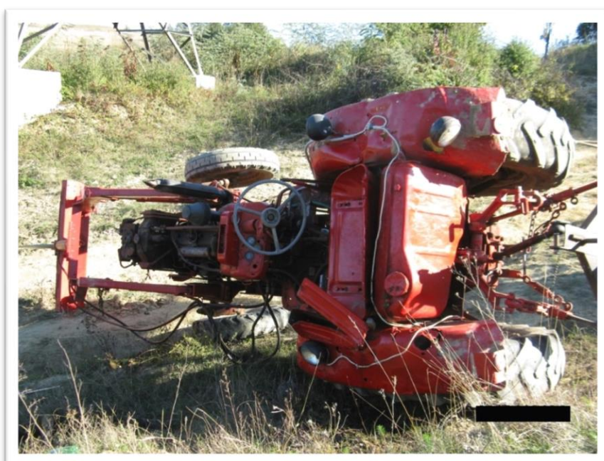
A fülke nélküli MTZ 50-es teljesen felborult, agyonnyomta a vezetőjét. Holttestét kiszabadítani csak a traktor oldalra borítása után lehetett.
