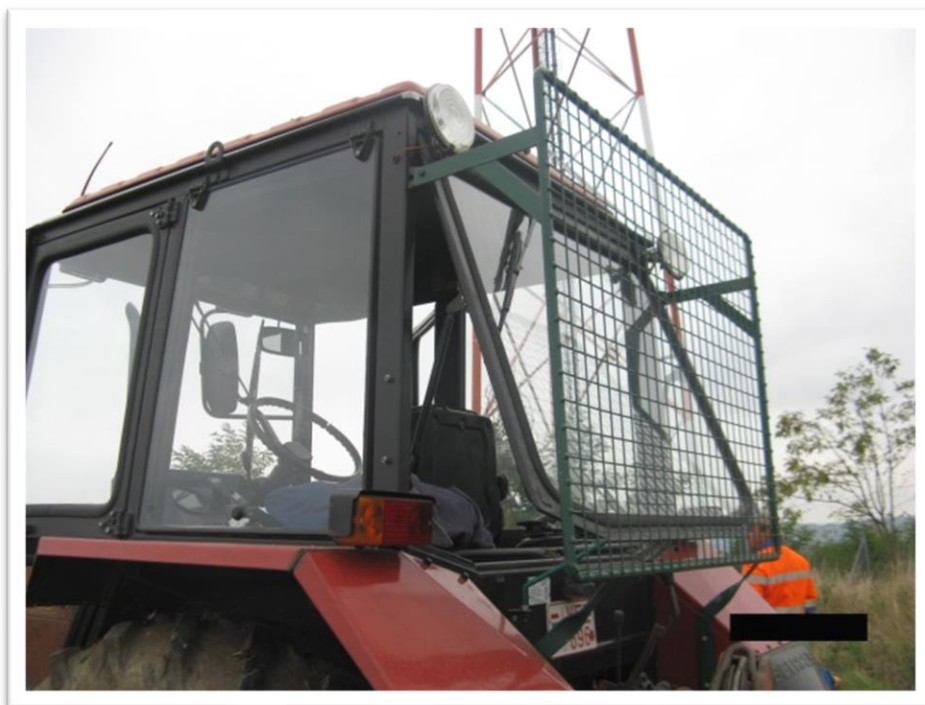
Mezőgazdasági traktor + csörlő+ védőrács = erdészeti közelítőgép. Megerősített fülke vagy bukókeret azonban itt sincs.
