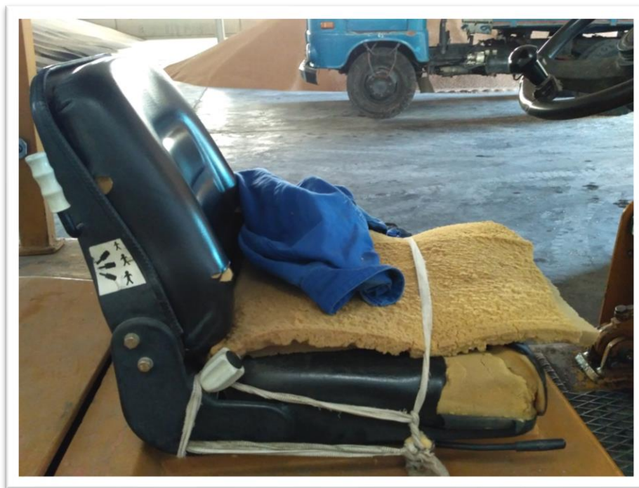
Elhasználódott, egyáltalán nem ergonomikus vezetőülés.
