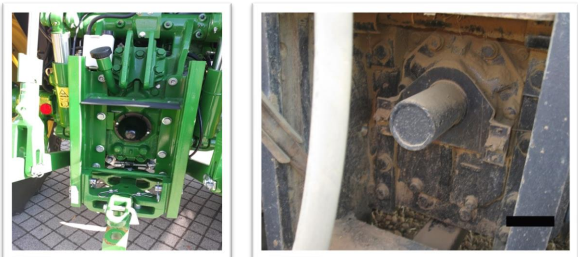
A teljesítmény leadó tengely védőburkolattal ellátva.
