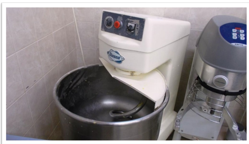
Helytelen gyakorlat - hiányos védőburkolattal rendelkező dagasztógép
