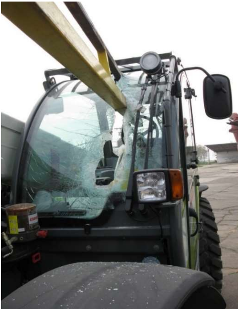
A vezetősín a rakodógép első ablakát betörte
