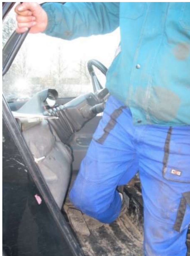
A teleszkópos rakodógép sebességváltó karjához véletlenszerű hozzáérés
