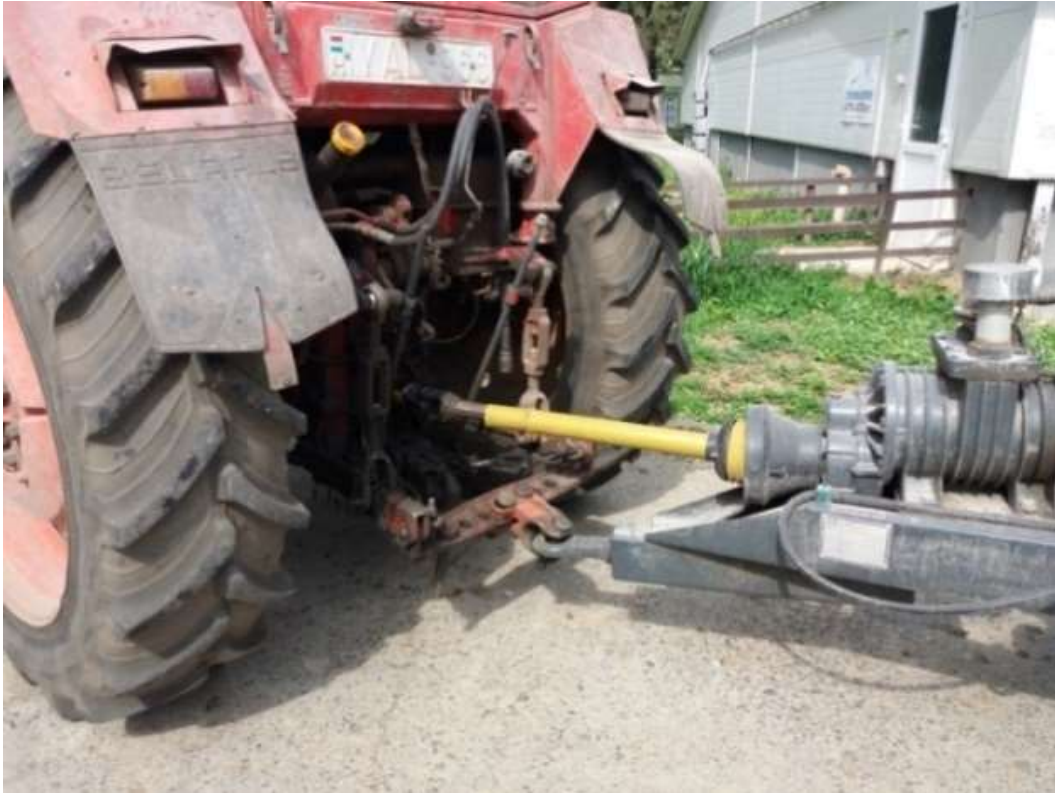
A teljesítmény leadó tengely védőburkolata hiányos, ill. nincsenek védőburkolattal ellátva
