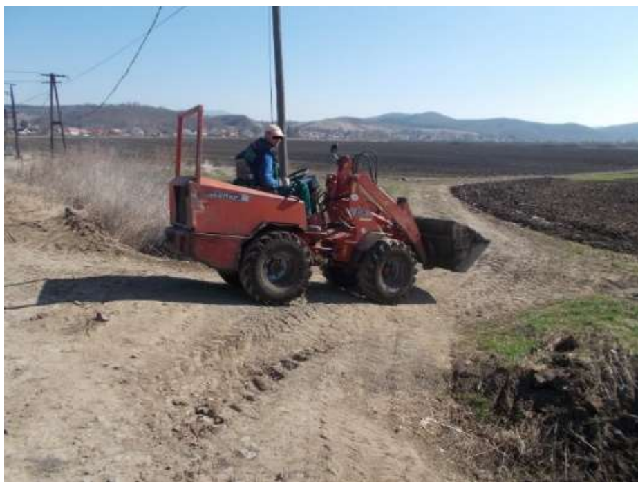
Szabálytalan, védőkeret nélküli rakodógép
