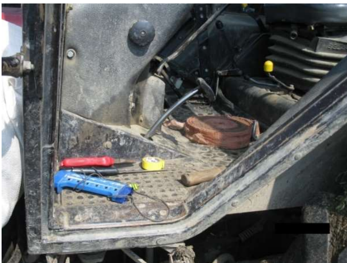
A rögzítetlen szerszámok a pedálok alá kerülhetnek, akadályozva a fékezést.
