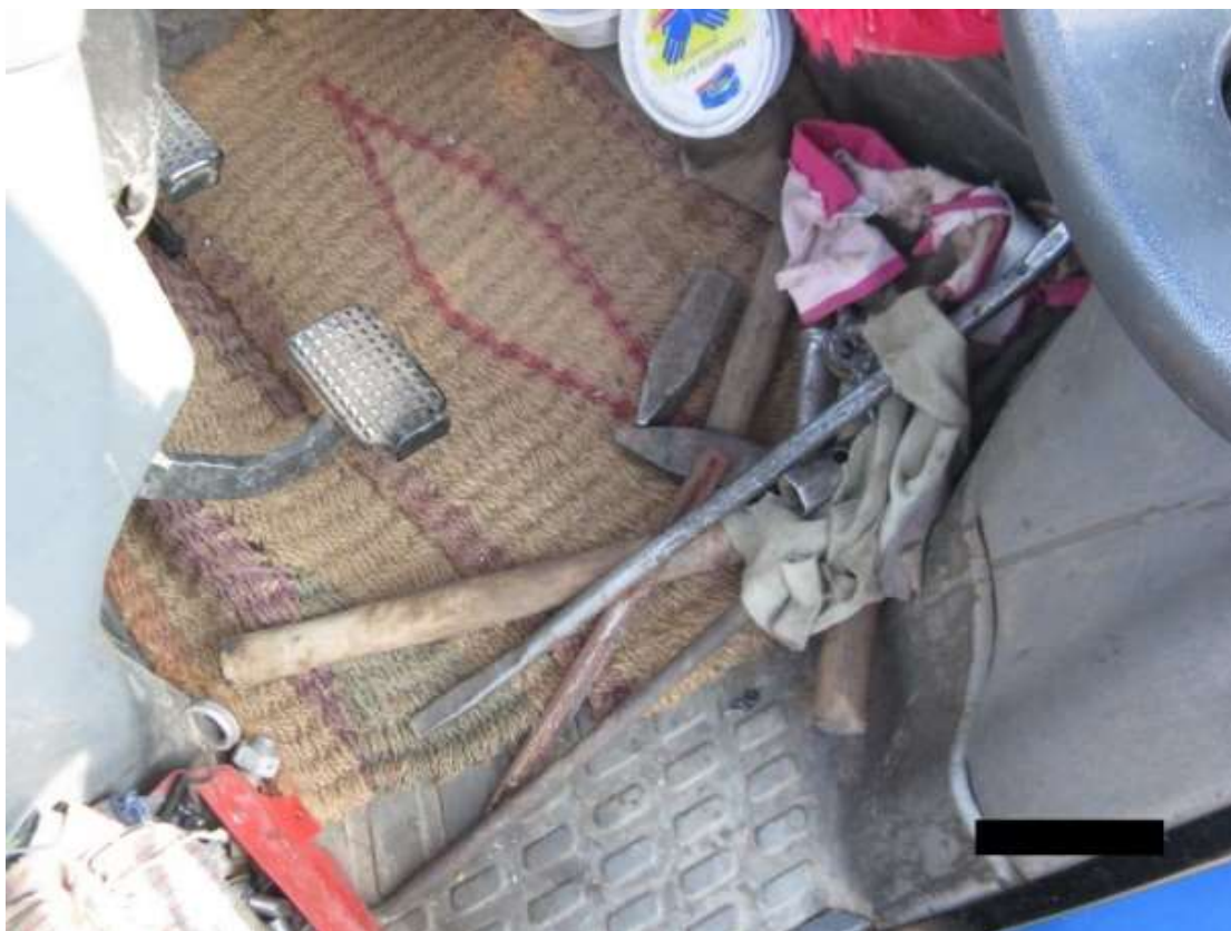
A rögzítetlen szerszámok a pedálok alá kerülhetnek, akadályozva a fékezést.
