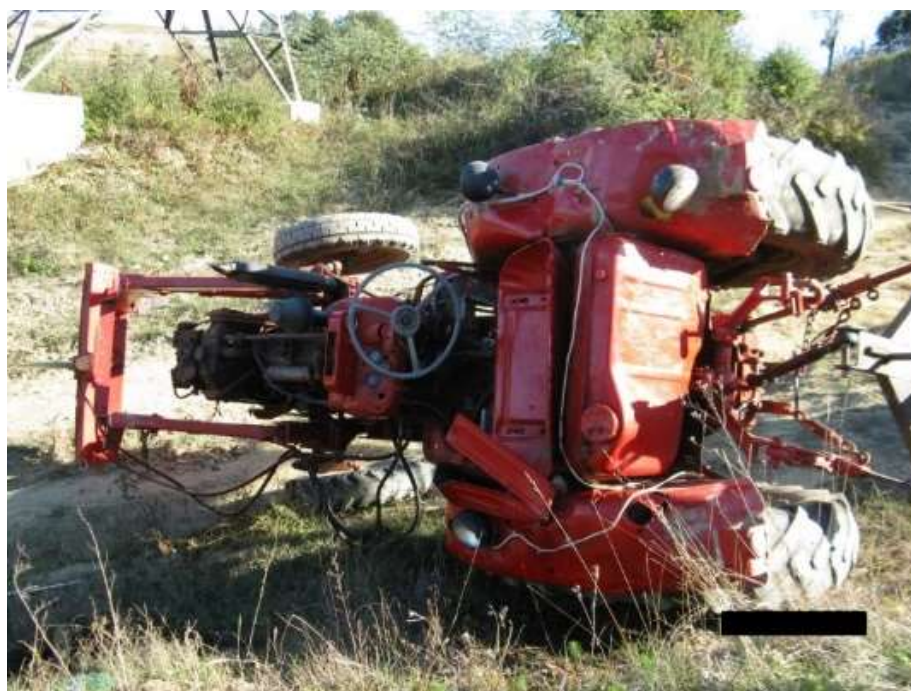
A fülke nélküli traktor felborult és agyonnyomta a vezetőülésből kizuhanó vezetőjét. Holttestét kiszabadítani csak a traktor oldalra borítása után lehetett
