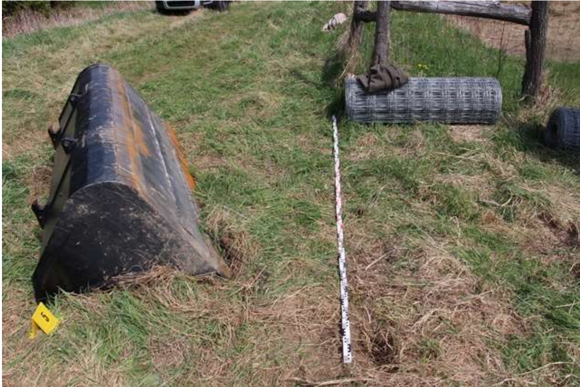
Az 1 tonnás homlokkanál 2 méter magasról a munkavállalóra esett
