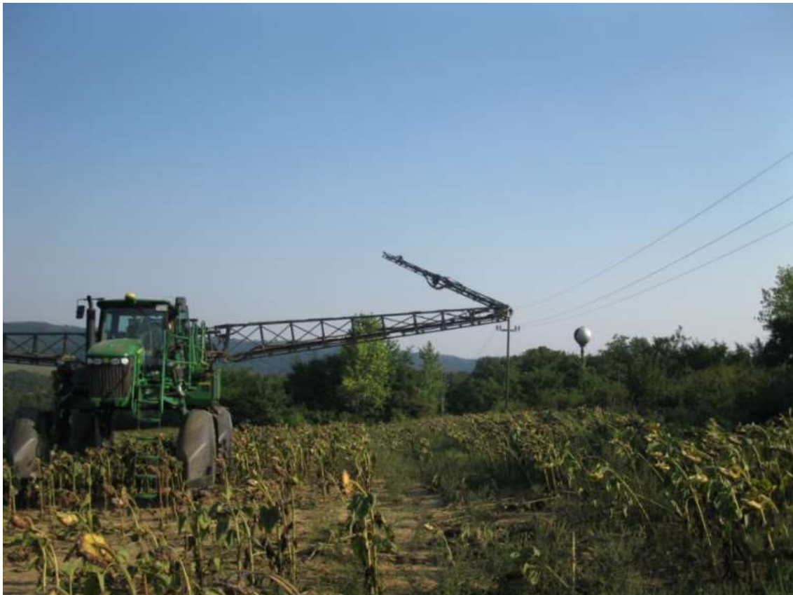
A keretes permetező kaja a villamos felsővezetékben elakadt
