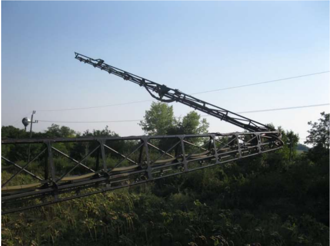
A keretes permetező kaja a villamos felsővezetékben elakadt
