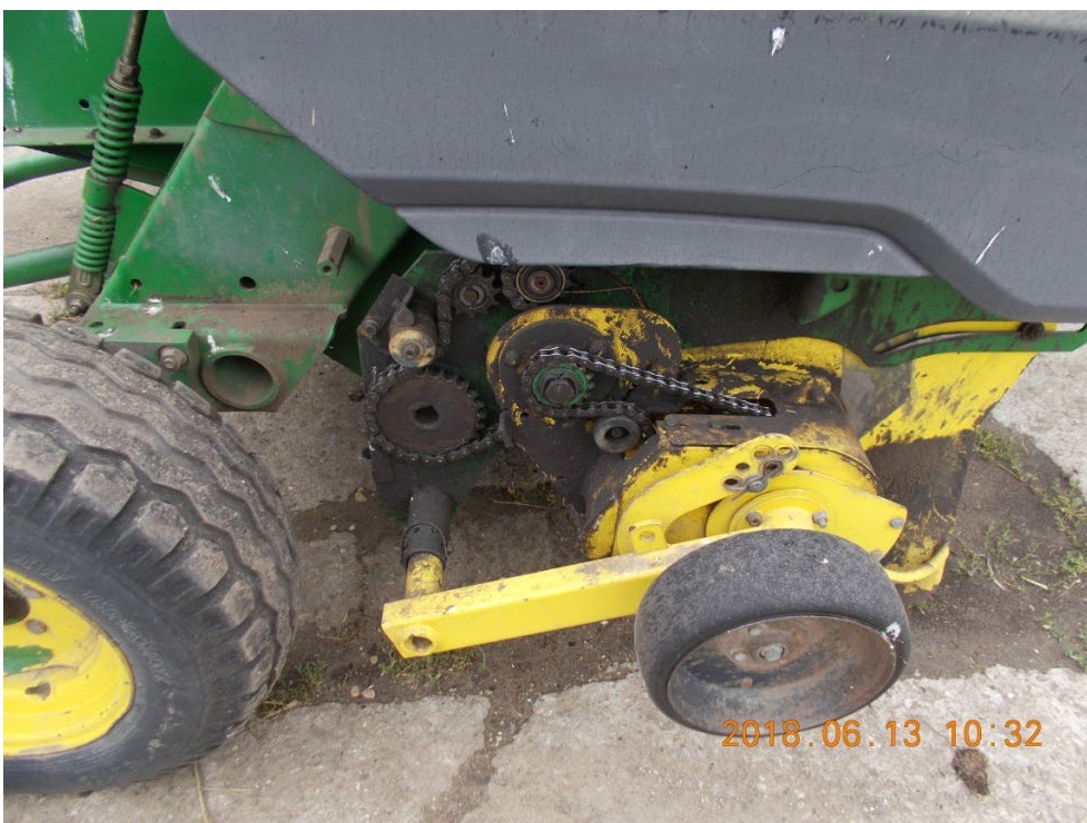
Bálázógép lánchajtásáról hiányzik a védőburkolat
