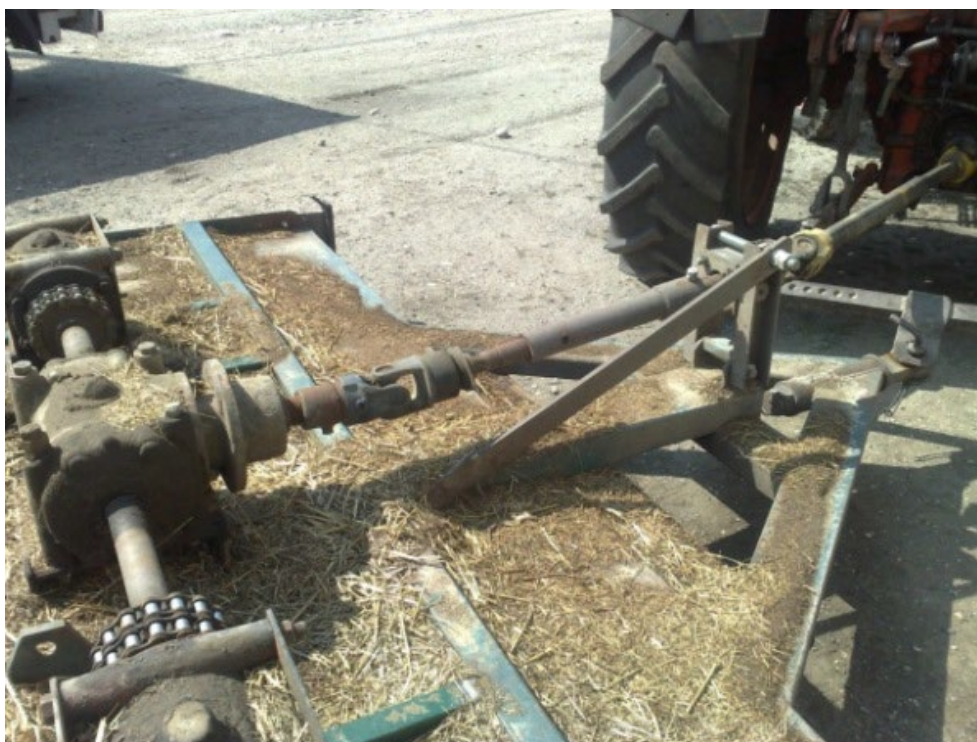
Traktor kardántengelye – védőburkolat nélkül
