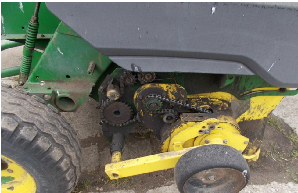
Bálázógép láncajtásáról hiányzik a védőburkolat
